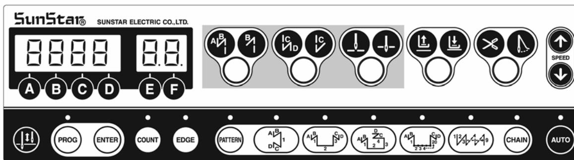
Метод пуска программы: Включите питание машины, нажимая одновременно на кнопки, указанные выше на рис., которые являются кнопками начала закрепки строчки и конца закрепки строчки + кнопку остановки игольной пластины в верхнем и нижнем положении.
