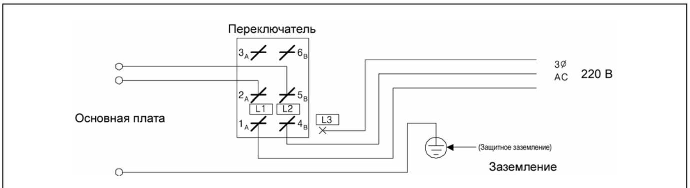
※ Не забудьте обеспечить защитное заземление
