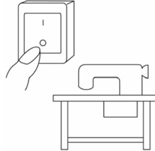
3. При ремонте сервомотора или замене иглы электропитание отключают.
