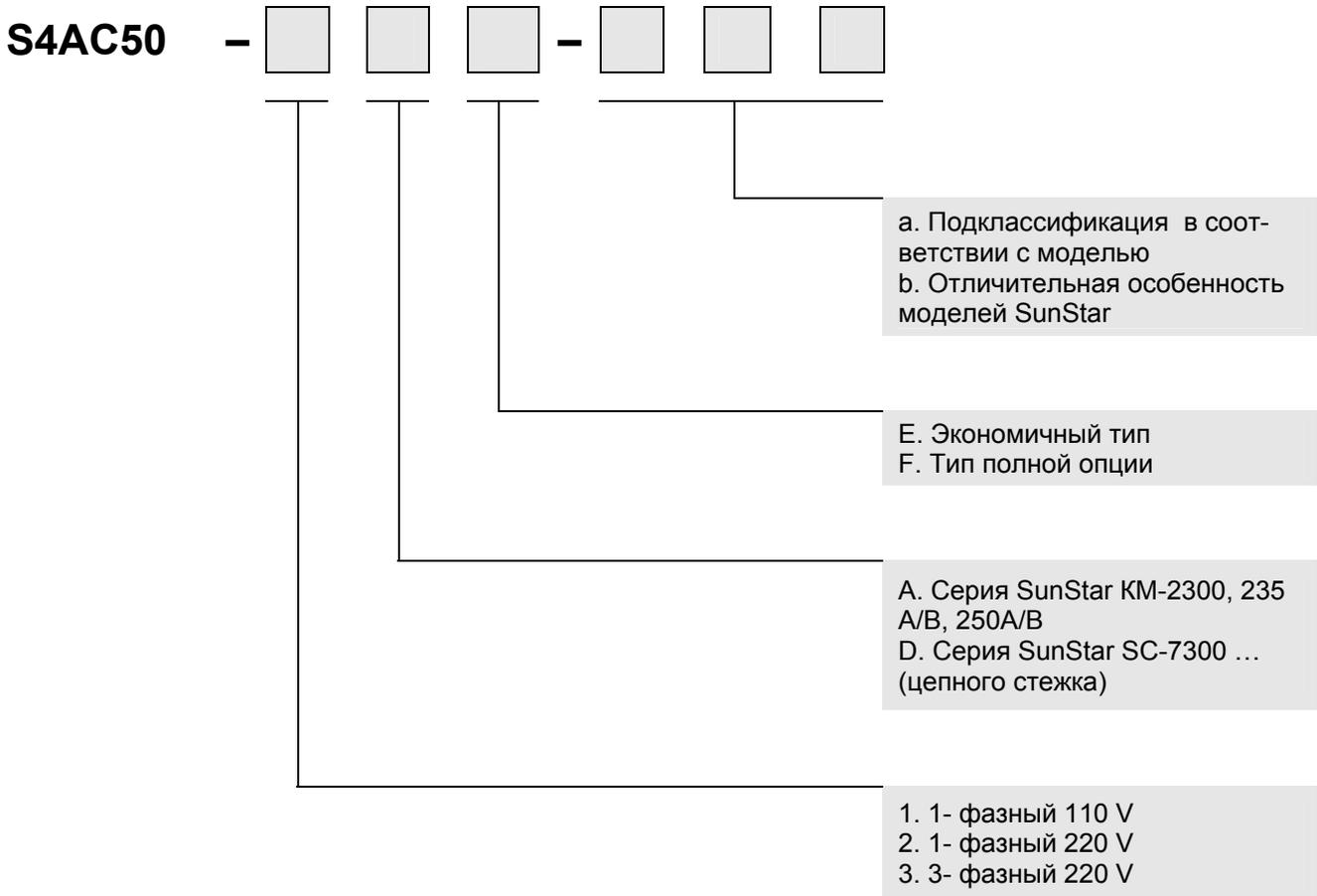
Пример заказа S4AC50-2AF относится к SERIES4, 1- фазный 220 V с коробкой управления полных функций для обычного зубчатого двигателя ткани.
