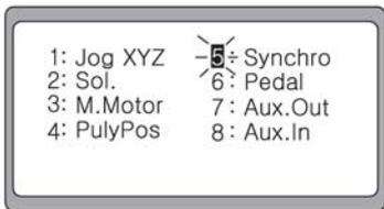
(2) Когда на экране появляется отображение проверки, проверьте, изменяется ли значение, вращая шкив вручную. При одном вращении шкива вручную значение увеличивается на 1.
