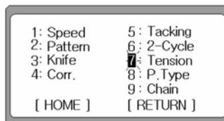
(2) На экране появится 1. Для установки натяжения выберите 5, используя клавиши UP (вверх) и DOWN (вниз), после чего нажмите клавишу ENTER (ввод).
