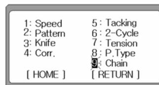
(3) При нажатии клавиши ENTER (ввод) дисплей изменится. Когда высветится режим установки функции Цепного пошива выберите ON, OFF из 1, используя клавиши UP (вверх) и DOWN (вниз).
