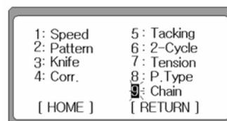
(3) Дисплей меняется и мигает 1 On Off. После, чего сделайте свой выбор, используя клавиши UP (вверх) или DOWN (вниз). Выберите 1 для установки, либо отмены функции цепного пошива.
