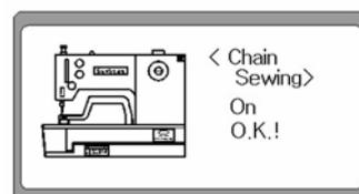
(5) Через секунду дисплей меняется. Для установки детальных данных в функции Цепного пошива выберите 2. Установите NO путем нажатия клавиши DOWN (вниз), после чего нажмите ENTER (ввод).
